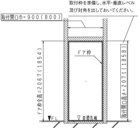
注意：床仕上面 (FL) 及び、沓摺の高さを考慮して、床を掘り込んでください。沓摺先端は、床仕上面 (FL) より5mm以上上げてください。
