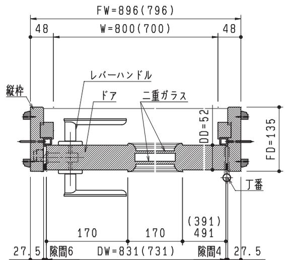
可変枠タイプ(壁厚110~239mmの場合)
