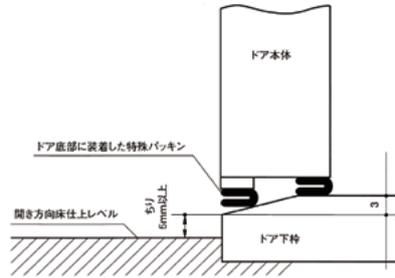
ドアの遮音性能の為に、床仕上面のレベルが大変重要です。レベルが悪い場合は、特殊パッキンがはずれて所定の遮音性能が出ない場合があります。沓摺先端と床仕上面には5mm以上のちりを必ず確保してください。
